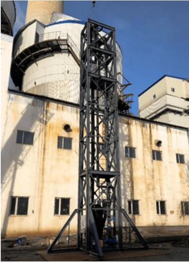
△ 海拉尔热电厂闪蒸提热试验台
